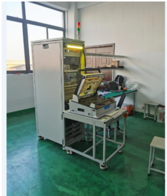
FCT测试治具主要是对产品进行功能测试如：电压、电流、功率、频率。FCT测试治具可以测试半成品或成品。如今FCT测试治具控制方式以全自动为主，这类控制方式的治具测试速度非常快且测试数据准确。测试时要根据被测试产品及客户的测试要求，选择较后的治具控制方式进行设计，设计出压板，载板等等模块。治具的压板或载板在设计时位置一定要精确，不能让产品在测试时把测试板压坏。FCT测试治具的定位要准确，连接器对接要顺畅。FCT测试治具都会有一定设计一个盒子，把测试产品置里内，在治具设计时一定要保持盒的充足的空间，盒内的布局一定要合理。FCT测试治具预留的接口位置应正确，足够、布局合理。南京多位板卡治具生产批发。FCT治具测试是针对同一系列的PCBA而定制开发的。
