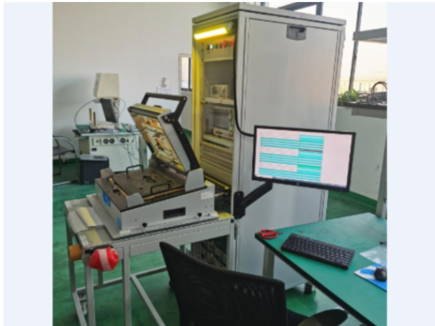
FCT设备的接口：随着自动测试技术的发展，传统的人工测试正在逐渐被自动测试所取代。GPIB和PXI等标准总线的出现大大简化了自动测试系统的开发复杂度，构建测试系统变成了组合各种仪器模块。但是UUT的类型还是复杂多样的，尤其信号类型也千变万化；因此，设计一个良好的连接UUT和测试资源TR的测试接口ITA是简化测试系统复杂度的关键。每个被测对象(UUT)具有不同的信号激励点和信号获取点，这些都需要一个接口以实现UUT 和TE的信号连接，此接口即测试接口适配器ITA。ITA负责完成UUT 和TE 的机械与电气连接，为TE各个信号点和UUT各个信号点指定路由路径。FCT功能测试治具能够在短时间内测试生产品在哪个区域及哪个零件的功能出现了错误。南京多位板卡治具生产批发
